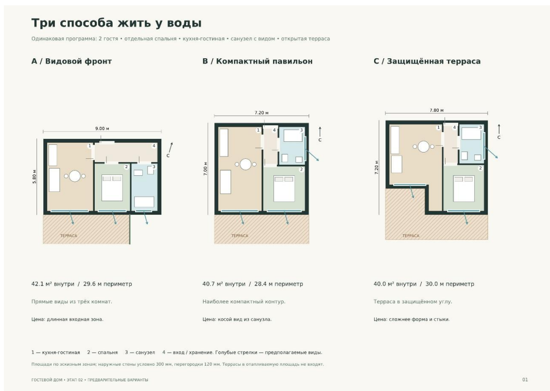
Рис. 3. Три варианта планировочного решения, полученные генеративной моделью по техническому заданию (1-я итерация)
