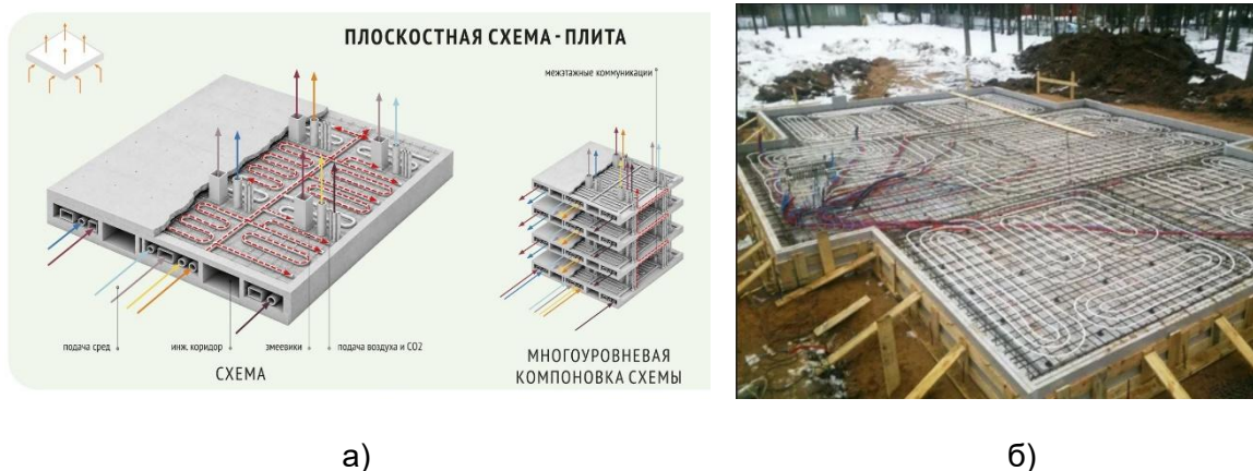
Рис. 8. Плоскостная схема плита : а) принципиальная схема распределения вторичных продуктов ТЭС; б) фото прототипа схемы
